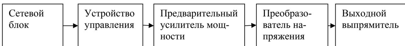
Рисунок 2.1 - Структурная схема надежности источника электропитания АТС
